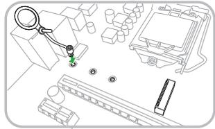
2. 將 M.2 SSD 卡插入 M.2 插槽。M.2 SSD 卡末端的凹槽正好對準 M.2 塑膠固定零件底座。
