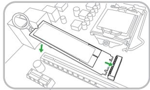
3. 將塑膠固定零件另一端的塑膠插銷插入底座的孔內以固定 SSD 卡。
